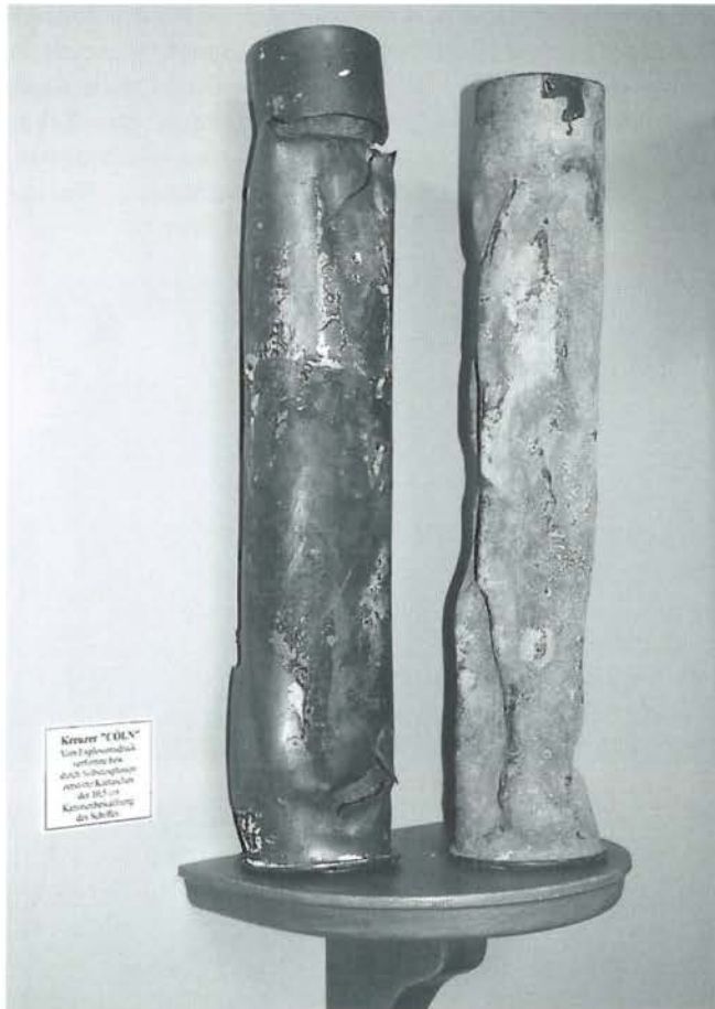
Durch Explosionsdruck verformte Geschosskartuschen im Dezember 1991 unserem damaligen Oberbürgermeister Norbert Burger überreicht worden.
